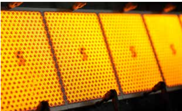
Keramische Brennerplatten von Schwank im Langzeittest
